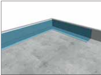
Polyfleece SX® 1000 wird entsprechend der Randschalungshöhe konfektioniert und umlaufend als Streifen mechanisch an der Randschalung befestigt. Der Überlappungsstreifen in der Horizontalen sollte mindestens 10,0 cm betragen.
